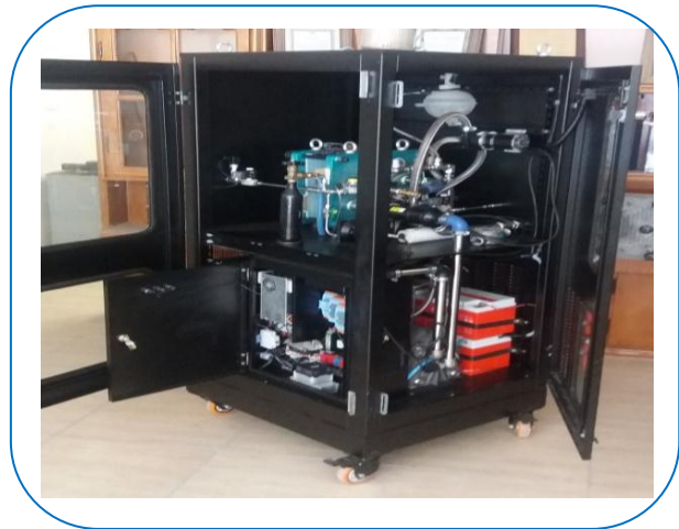
سیستم پیل سوختی پلیمری ۵ کیلووات مستقل از شبکه
