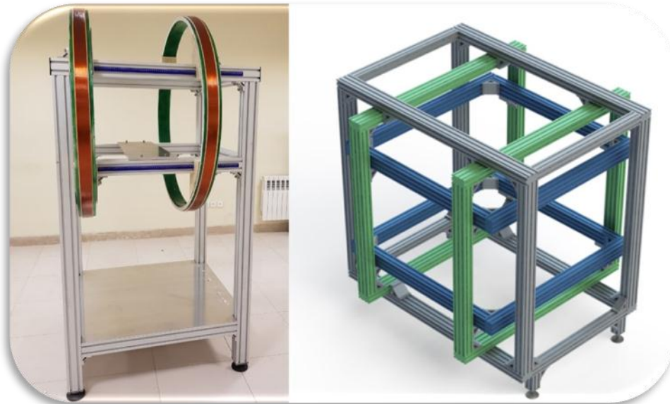
شکل ۱: عکس سیم‌پیچ هلمهولتز یک محوره (چپ) و شماتیک سیم‌پیچ هلمهولتز سه محوره
